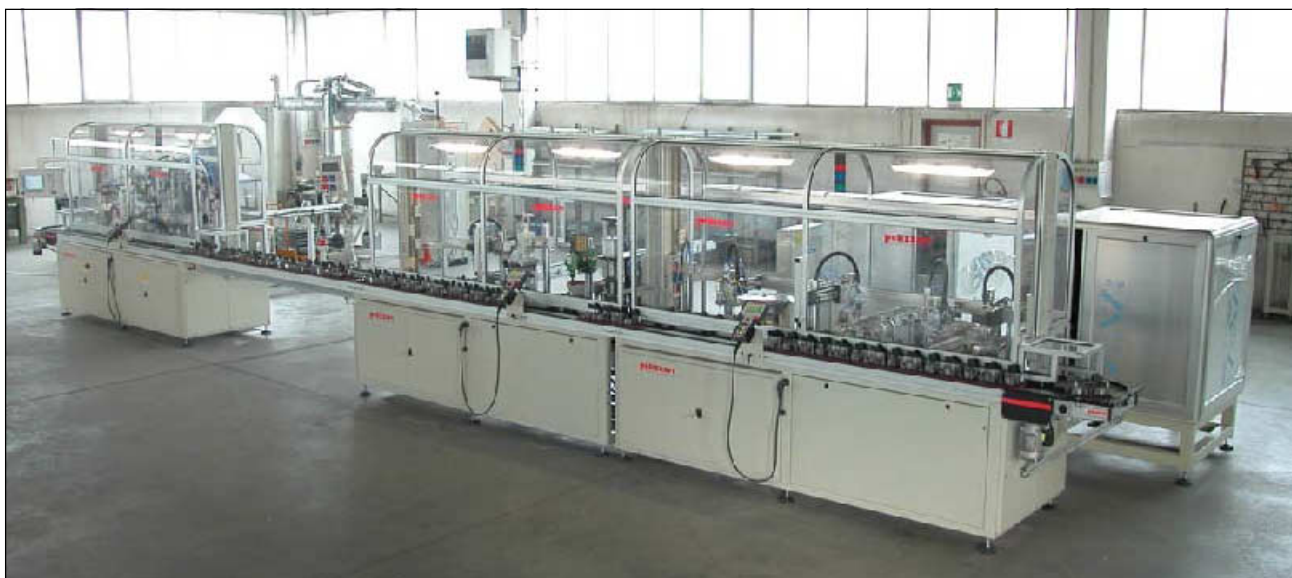
Linea automatica montaggio motori a poli schermati Automatic shaded pole motor assembly line Ligne automatique de montage des moteurs à bagues de déphasage.
